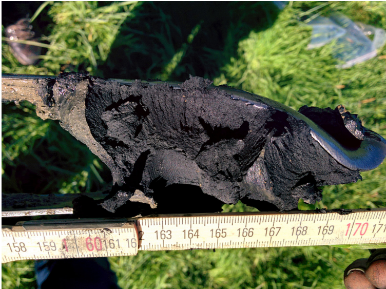
Figur 13. Sulfidhaltiga jordar kännetecknas ofta, speciellt i norra Sverige, av en karakteristisk svart färg. När jorden exponeras för luft försvinner den svarta färgen då sulfidmineralen oxiderar. Den processen leder ofta till att jordens pH sjunker drastiskt. Foto: Gustav Sohlenius, SGU.
